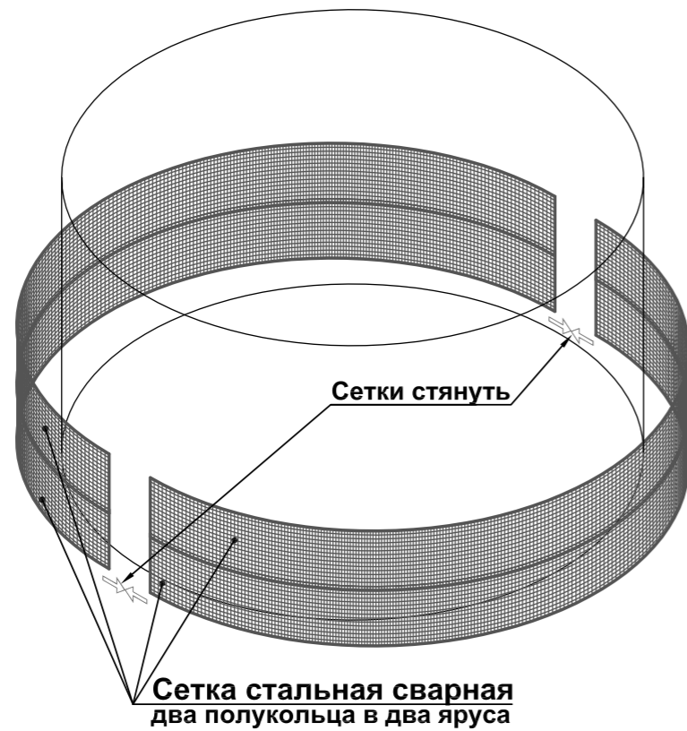
Узел монтажа стальной сварной сетки на резервуаре
